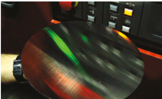
Actual SineWave finish on high nickel alloy.
